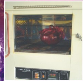
實際烘箱100°C荷重5KG / 8HR Oven 100°C, load 5kg/8hr
