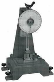
衝擊試驗機是以角度 150 度來測試各種硬質材料的試件。一定重量自由落下撞擊試件後，擺臂帶動指針以小於 150 度之角度升高，由指針指示角度換算試件所能吸收之能量，以判定材料之衝擊能量。
