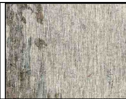
圖 1：鋁片未經表面處理，高溫高濕實驗後表面鏽蝕的照片。
