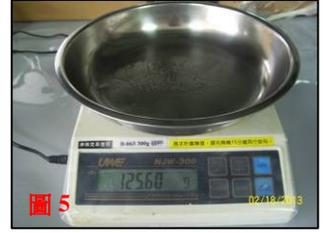
溶劑型產品常有固成份檢測這個項目，檢驗方法不外乎用天平來秤重。最精密的天平莫過於熱重量分析儀 (TGA, 圖 1~3)，利用它來做步階等溫掃描可以獲得非常準確的結果。其次利用 0.1 毫克的精密天平(圖 4)也可以獲得很好的數據。如果沒有上述設備，一般磅秤(圖 5)也可以又快又簡單的量測固成分，實驗的步驟敘述如下：1.在磅秤歸零後放上空秤盤，記錄其重量(Wo)。2.在空秤盤上倒入樹脂，記錄其實際重量(Wa)。3.將秤盤和樹脂在特定的溫度和時間加熱，然後再記錄溶劑揮發以後的重量(Wb)。固成份的計算： $\text{Solid content} = (Wb - Wo) / (Wa - Wo)$
