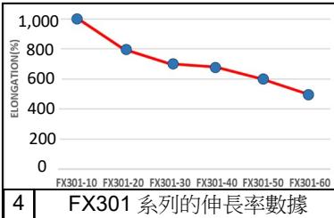
我們最近成功開發的液態矽膠 (LSR) FX301 系列，產品為雙液鉑金硫化彈性體。本產品具有許多優異的特點：高溫下穩定性好、耐化學性佳、良好的電絕緣、低溫下擁有優異的柔軟度和流動性。
