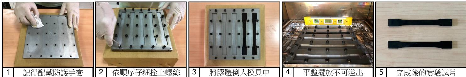
拉伸強度(tensile strength)也稱為抗張強度。塑膠的「拉伸試驗」是常見的機械特性測試方法，其主要目的在測試樣品於靜止狀態下，所承受荷重時的抗拉能力。實驗也可同時得知塑膠的強度、韌性及延展性...等性質。在塑膠材質的規格表中，通常採用 ASTM D638 標準，其單位為 Mpa 或 psi。永寬製作流程：參照 ASTM 規範的試片規格製作之模具，將其表面清潔乾淨後，均勻擦拭脫模劑(圖 1)。結合模具上下部後，以交叉對稱方式將螺絲平均鎖緊(圖 2)。膠水填滿模具後，放入抽真空去箱除多餘氣泡(圖 3)。放入烘箱並架設水平，依照溫度條件進行固化(圖 4)。膠水固化後拆除模具螺絲，取下試片(圖 5)。
