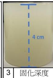
永寬化學研發出改性矽膠 FS211 系列，克服上一期所提及一般矽膠的缺點，得到氣味小、腐蝕少、低 VOCs，且能短時間內深層固化的 1:1 雙液型膠水。由圖 1 所示，高溫 120°C 環境測試接著力，雖然有小幅衰退但仍維持初始接著力的 92%；高溫 150°C 環境測試接著力，維持初始接著力的 85%。圖 2 顯示的是金屬鋁跟鋁之間的黏接。在濕氣難以滲入的環境中，使用雙液型的 FS211 系列也能在 2 小時後獲得 37% 的接著力。這個配方在 24 小時後接著力達到完全固化的 70%。當然，完全固化的時間需要視膠量而定，但是都不會大於 7 天。這個接著劑能夠克服單液濕氣樹脂 (RTV1) 固化深度無法超過 1 公分的瓶頸。FS211 系列能夠在一般的環境 24 小時內固化深度達 4 cm (圖 3)。這個系列不論是外觀色澤、黏度、抗垂流性、固化時間及接著強度，都還可以進行調整。歡迎您來電洽詢。
