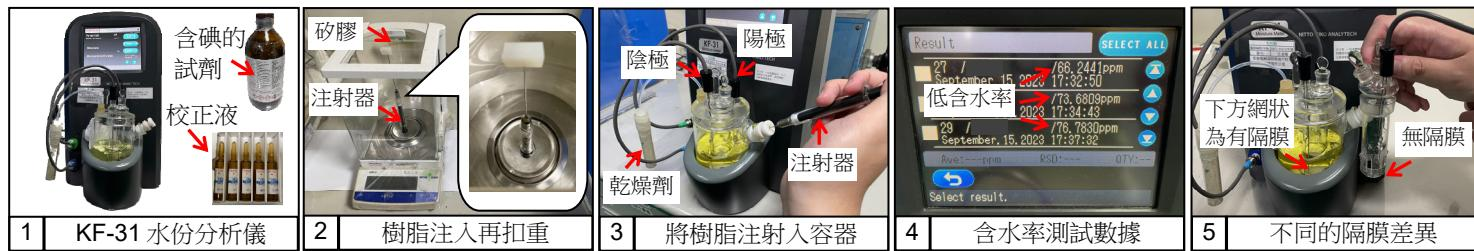
某些應用需要控制材料的含水率。為了提高產品的品質，為了能更快回覆客戶需求，繼原有的容積法水份滴定儀之後，我們新購入庫倫法的水份分析儀 KF-31 (圖 1)。新儀器的介面更清楚、樣品測試更快速，更準確的測試低含水率的產品 (圖 2~4)。容積法和庫倫法都是使用 Karl Fischer 試劑的碘，與測試物中的水進行反應，進而測出含水率。容積法的優點是，可以測 0.1~100 % 級的含水率，庫倫法可以測得 10~10,000 ppm 級的含水率。庫倫法擴大了含水率的測試範圍，加上添購具備無隔膜和有隔膜的電極 (圖 5)，提升溶劑型產品測試時，因溶劑含水率不同造成的數據誤差。無隔膜只需陽極的電解液，可測試醇類產品；有隔膜需陽極及陰極的電解液，可測試醛酮類產品。新的水份分析儀可以量測更低的濃度，可以適用更多的化學材料，對我們的產品開發與品質控制都是一大利器。
