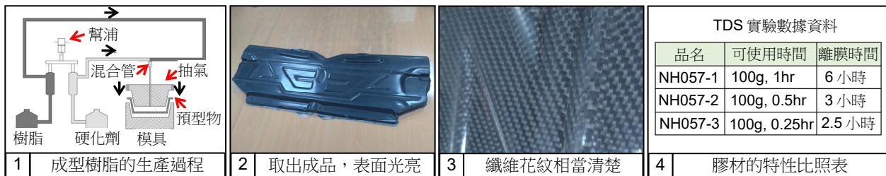
RTM (樹脂轉注成型 Resin Transfer Molding)是製造高分子複合材料的技術。其製程是將未含浸樹脂的纖維壓成「預型物」，再把它置入封閉的模
