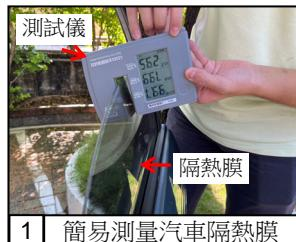
1 簡易測量汽車隔熱膜
