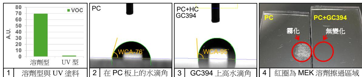
為了符合 ESG 永續發展的精神，許多公司正在推廣再生能源、使用環保包裝、重視綠色消費、控制溫室氣體排放、避免釋放揮發性有機化合物 (VOC)...等。永寬化學開發出「無溶劑，低VOC的UV塗料，產品型號GC394系列。這款產品有效減少VOC的排放量外，塗布在PMMA、PC上有良好的接著強度和優異的鉛筆硬度，能抗刮、耐磨耗、耐指紋和耐溶劑，表面光滑有高水滴角，非常適合當做廚具的保護塗層。以5 mm 的PMMA與3 mm 的PC為例，塗佈GC394，以80 °C熱烘烤1~2分鐘後，接著以紫外光照射(600~800 mJ/cm<sup>2</sup>)，可在板材上形成5 μm的透明保護塗層。鉛筆硬度在PMMA上為4H/750 g，在PC上為F/750 g (圖2~4)。歡迎有興趣的您與我們聯繫。
