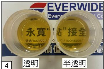
灌封膠可用來保護電子組件，需具備良好的電氣絕緣性。相較於常見的含氯環氧樹脂、有揮發物的矽膠、含異氰酸酯的聚氨酯體系灌封膠，新開發的 JE381 較環保、安全無毒外，吸水率實驗證明 JE381 的防水性更好、水氣穿透率更低 (圖 1)。JE381 的玻璃轉化溫度 ( $T_g$ ) 小於  $-60^\circ\text{C}$ ，Shore A 為 5，摸起來相當柔軟 (圖 2)。低溫下的應力低、反應放熱低及收縮率小，因此可防止電子零件受損。除此之外，JE381 可室溫固化，不受設備限制，還可以重複拆解再灌注 (圖 3)。JE381 系列雙液膠水為酸酐與醇類的反應，添加可塑劑能使黏度降低 (約為 500-1200 cps)，提升操作性及混合均勻性。不同的可塑劑會影響膠塊的透明度 (圖 4)，相容性太差會發生分相。降低可塑劑的含量可提高固化速率及硬度，進而客製化配方。若您有相關需求，歡迎與我們聯繫。
